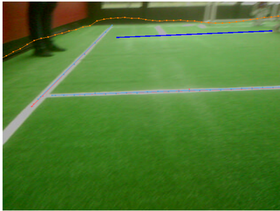
(a) Reflexion des Sonnenlichts am Kunstrasen kann zu Fehlerkennungen führen
