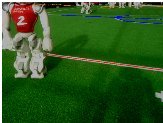
(a) Nicht gefundene Linie im Nahbereich (rot). Weiter entfernte Linien werden gefunden (blau).
