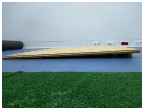
Abbildung 6.2 Die geneigte Holzplatte mit 2.1 Grad Neigung
