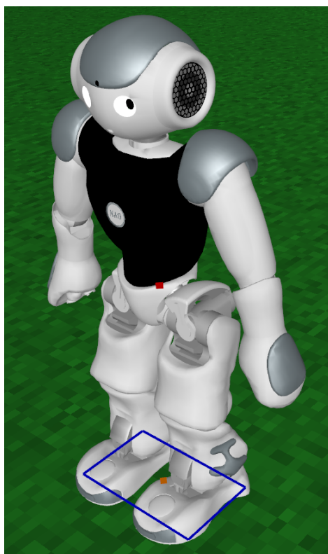
Abbildung 5.14 Das Stützpolygon (blau) mit dessen Mittelpunkt (orange) und der Schwerpunkt des NAOs (rot)
