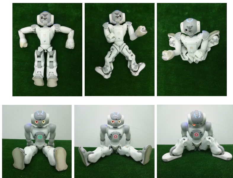
Abbildung 5.7 Bewegung Front Von links nach rechts: Arme nach hinten bewegen und aufrichten Auf diese Bewegung folgt FromSplitt (siehe Abbildung 5.12)
