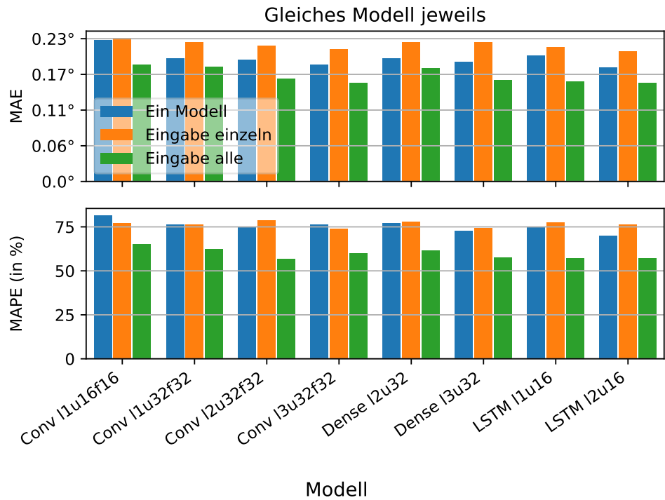
Abbildung 5.23: Auswahl an Trainings aus den drei bisherigen Experimenten, bei denen das gleiche Modell verwendet wird, wobei diese sich in der Anzahl der Ein- und Ausgaben unterscheiden. Weiterhin ist zu beachten, dass es bei den Varianten welche jedes Gelenk mit einem einzelnen Modell vorhersagen, entsprechend elf Netze gibt. Die Modellnamen bestehen aus dem Namen der Architektur und der Konfiguration des Modells. l steht für die Schichten, u für die Einheiten pro Schicht und f für die Conv-Filter, die sich für die verschiedenen Architekturen konfigurieren lassen.
