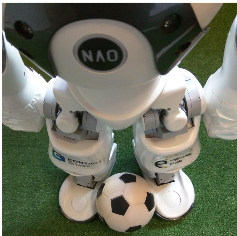
Abbildung 7.6 Die V-Form der Füße beim neuen Standard-Schuss
