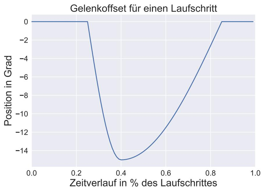
**Abbildung 6.5** Ein Beispiel für die Umsetzung der Offsets für einzelne Gelenke. Hier wird ab 25 % des Laufschrilles ein Offset berechnet, welcher bis 40 % des Laufschrilles maximal wird (-15 Grad) und anschließend bis 85 % des Laufschrilles auf 0 zurückkehrt.
