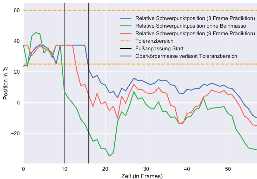
**Abbildung 5.17** Verschiedene Schwerpunktmassen im Vergleich. Der Zeitpunkt, zu dem die Laufschrattanpassung eingriff, ist durch die schwarze Markierung dargestellt. Die Oberkörpermasse verließ hier aber sechs Motion-Frames zuvor (graue Markierung) den definierten Toleranzbereich.
