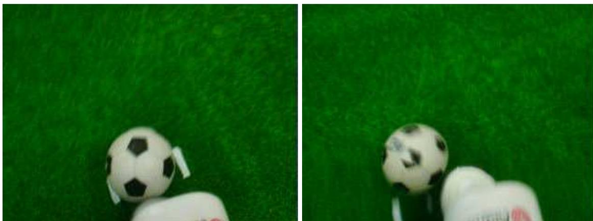
**Abbildung 6.9** Vergleichen der Moment, in dem der Ball beim langen Vorwärtsschuss getroffen wird, wenn der Roboter während des Schusses nicht rutscht (links) und wenn der Roboter rutscht (rechts)
