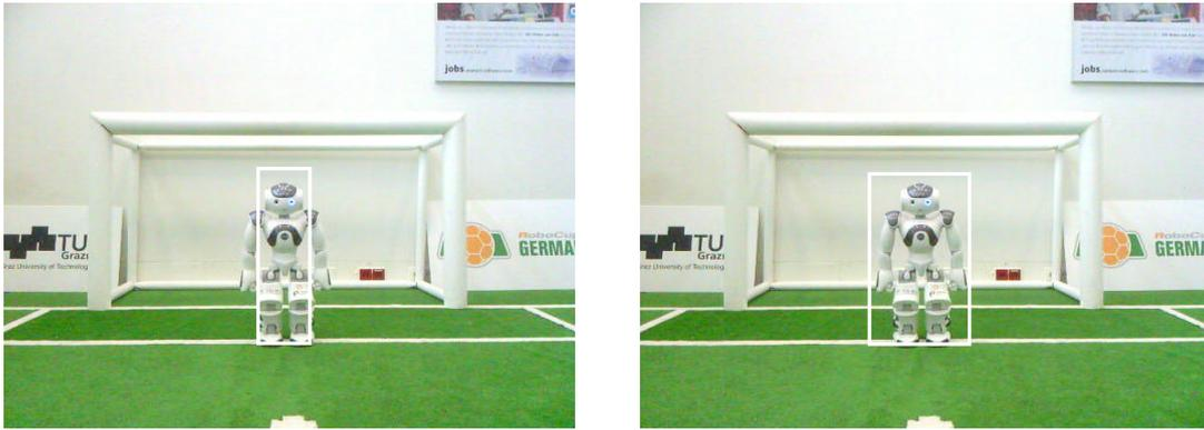
Abbildung 6.3: Die Abbildung zeigt eine Detektion des momentan verwendeten Detektors (links) und eine Detektion des in dieser Arbeit vorgestellten Detektors (rechts). Es wurde das *Hybrid-Modell* verwendet.
